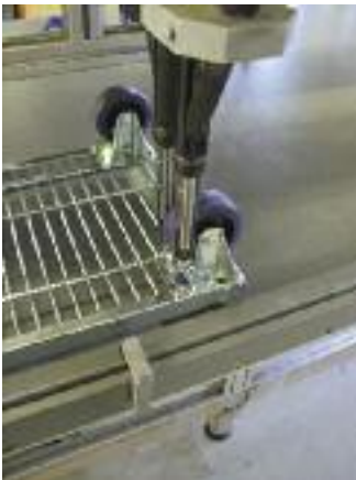
Manuelle 2-fach Schraubstation für Verschraubung von Radsätzen an Gitterwagen mit Schraubenzuführung. Spezialmundstücke mit Greifern für die exakte Platzierung der Schraube. XY-Verfahrsschlitten.
