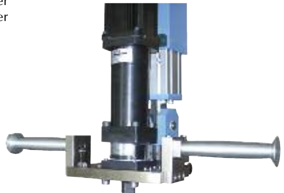
Handgeführter Schrauber an Linearteleskop für 320 Nm an einem Einzelarbeitsplatz
