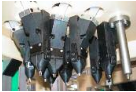
10-fach Schraubstation für Verschraubung einer Ölpumpe mit Schraubenzuführung. Spezialmundstücke für enge Platzverhältnisse. Vernetzung über Profibus.
